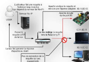
Figure 45 : Schéma échanges no-IP
