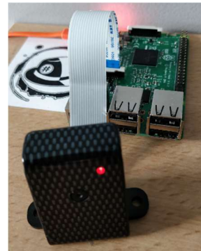
Figure 46 : Raspberry Pi et Caméra
